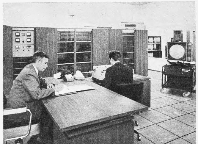
Bild 2. Das Herzstück des Simulators in Brétigny ist der Telefunken-Rechner TR 4
