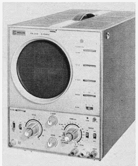
Der Hf-Oszillograf PM 3221 von Philips hat eine Bandbreite von 10 MHz. Auf Grund seiner niedrigen unteren Grenzfrequenz eignet er sich auch für Nf-Untersuchungen
